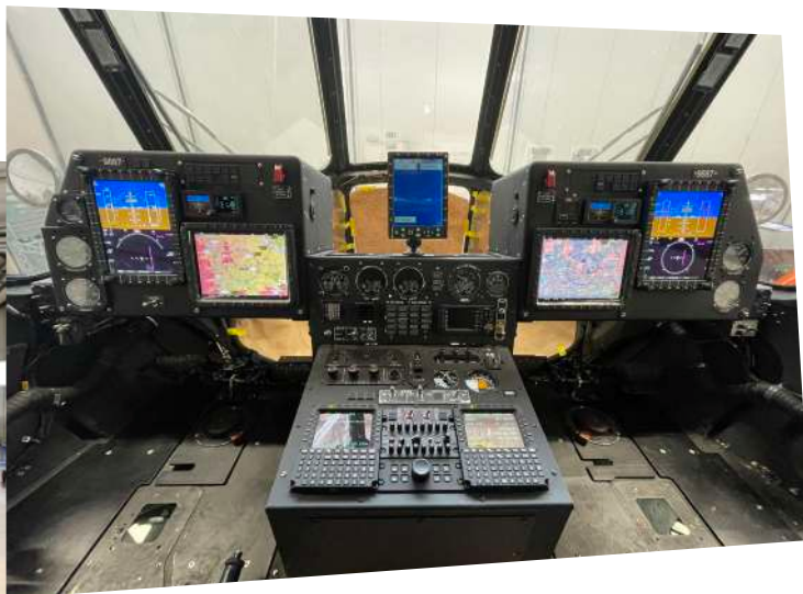
Detail kokpitu modernizovaného vrtulníku Mi-171Š „KROVKA“
